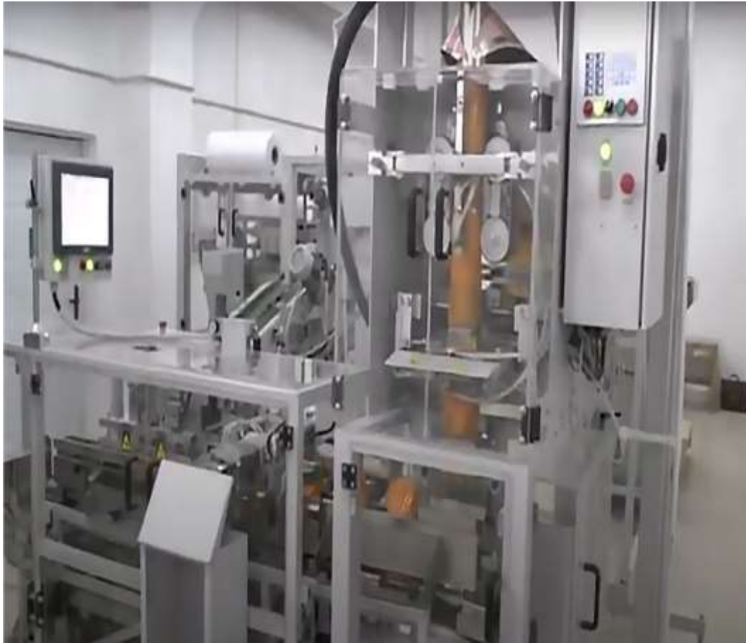
Завантажувальний бункер Завантажувальний транспортер ЗТ-1 Приймальний бункер Автомат з дозаторами Лінія формування пакетів в форму брикета
