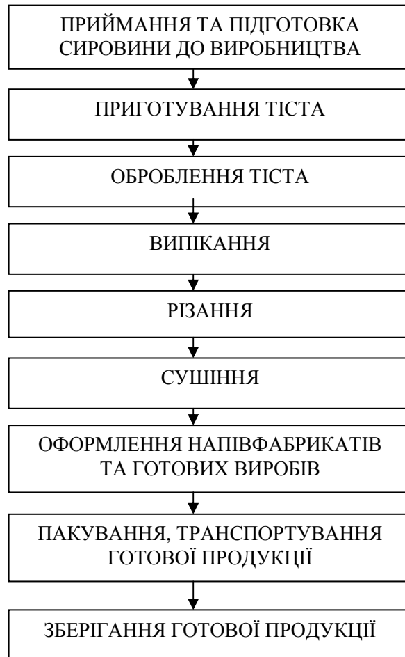
Рис. Узагальнена схема технологічного процесу виробництва хліба та хлібобулочних виробів
