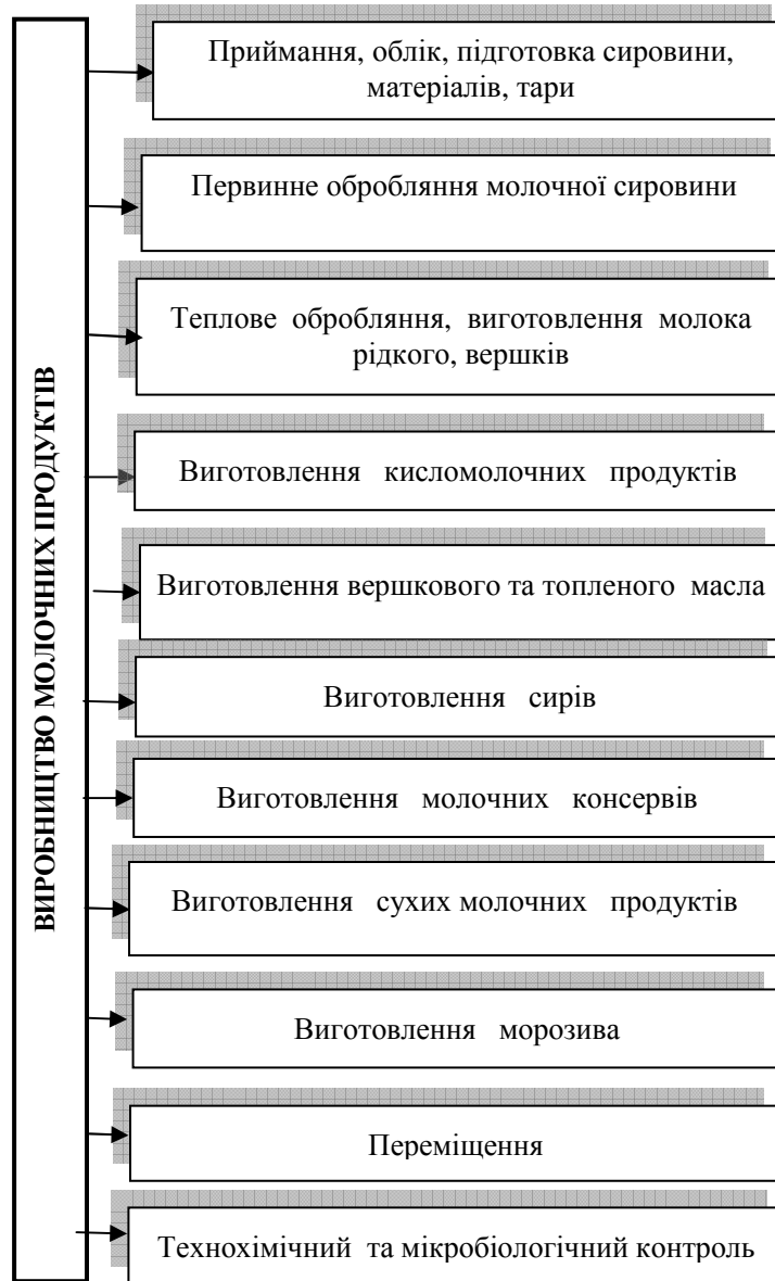
Рис. 1. Узагальнена схема технологічного процесу виробництва молока та молочних продуктів
