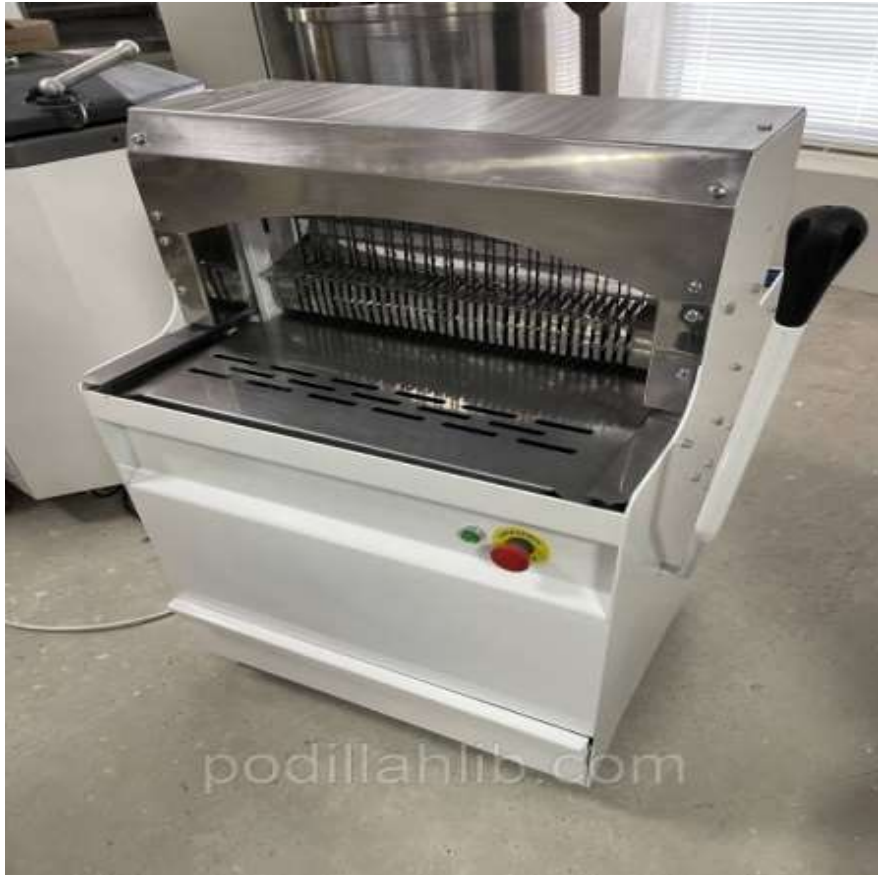
Хліборізальна машина фірми Gіtak продуктивністю до 500 шт./год
