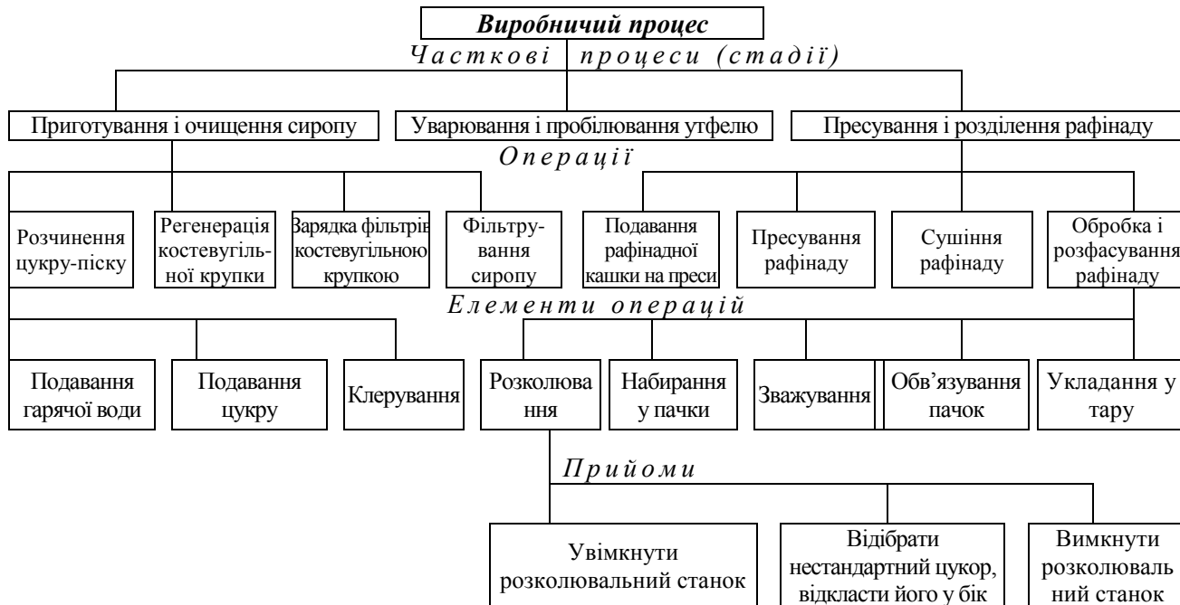
Рис. 2. 2. Схема виробничого процесу виготовлення цукру-рафінаду пресовим способом
