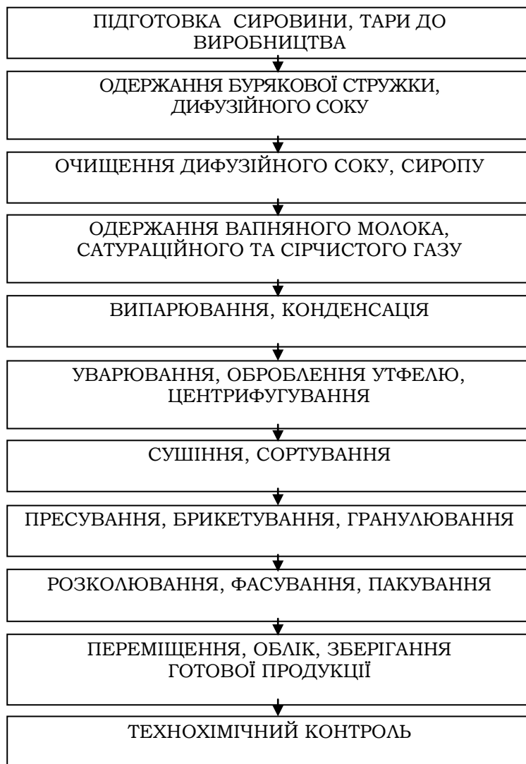
Рис. 3.1. Узагальнена схема технологічного процесу виробництва цукру [21].
