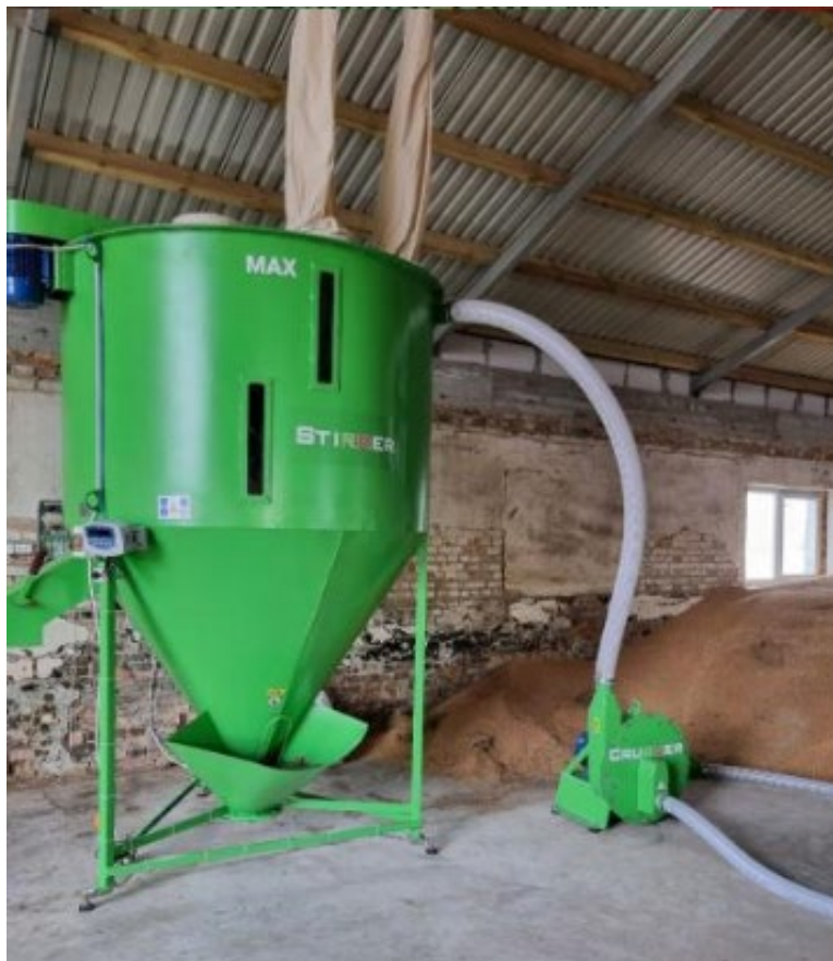
Лінія для приготування корму: змішувач сипких кормів Н037/3 1500 кг + подрібнювач 11 кВт
